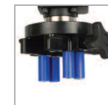
Piastra di afferraggio superiore, apertura mm 10-78 (da usare solo con celle da 6 e 10nm)
